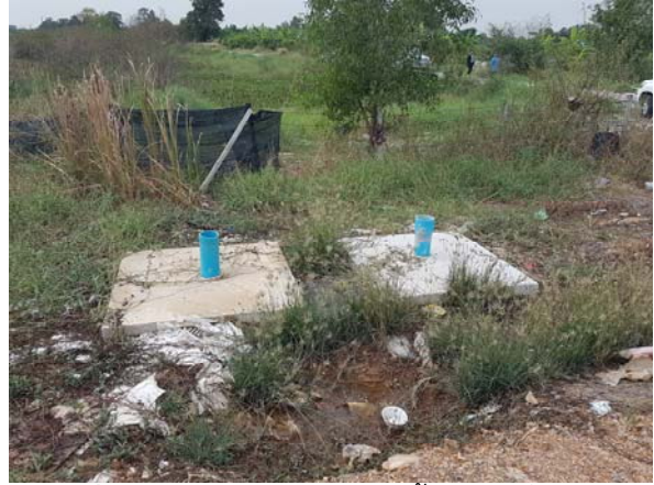
รูปที่ ๙ บ่อตรวจสอบคุณภาพน้ำใต้ดิน ซึ่งยังไม่ถูกต้องตามรูปแบบบ่อตรวจสอบคุณภาพ
