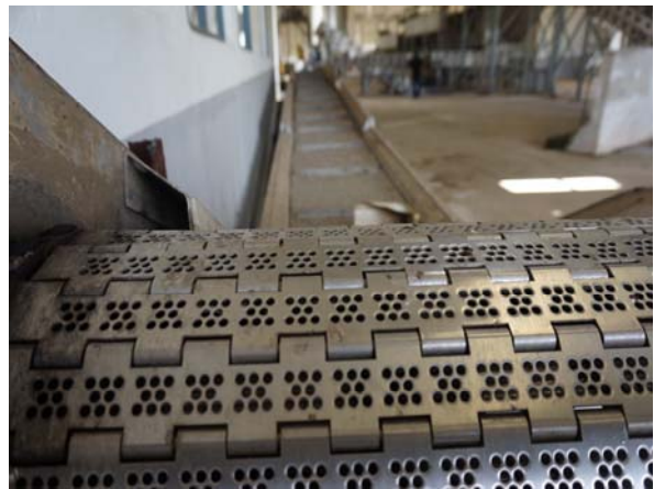
(ข) สายพานเดิม ซึ่งเป็นโลหะผสม ซึ่งมักเกิดปัญหาบริเวณเหล็กยึดข้อต่อแต่ละชั้นที่อาจเกิดการกัดกร่อนจากกรดที่เกิดจากการหมักขยะ
