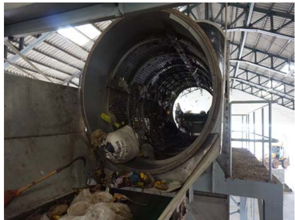
(ง) ตะแกรงร่อน (Trommel) สำหรับร่อนวัสดุขนาดเล็กออกเพื่อไปยังระบบหมักปุ๋ย
